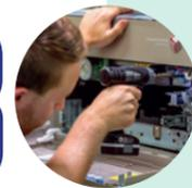
La machine est ensuite réassemblée sur une chaîne de production industrielle standard à l'aide de pièces existantes et neuves. Les disques durs sont effacés et reformatés, et la machine est mise à niveau vers la dernière version du micrologiciel applicable. Les compteurs sont remis à zéro, la machine reçoit un nouveau numéro de série et bénéficie d'une nouvelle garantie constructeur.
